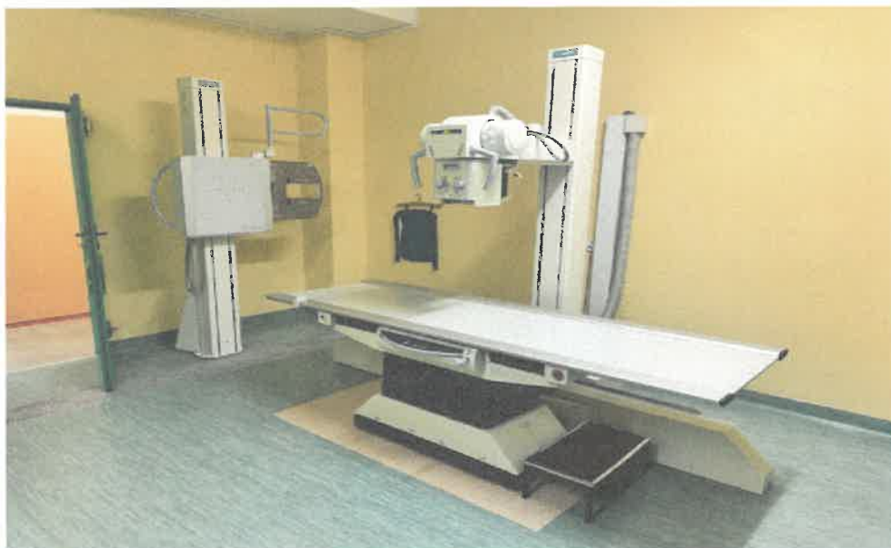
Zdjęcie nr 1 - zestaw RTG do prześwietleń kostno - płucnych SIEMENS Multix/Vertix
